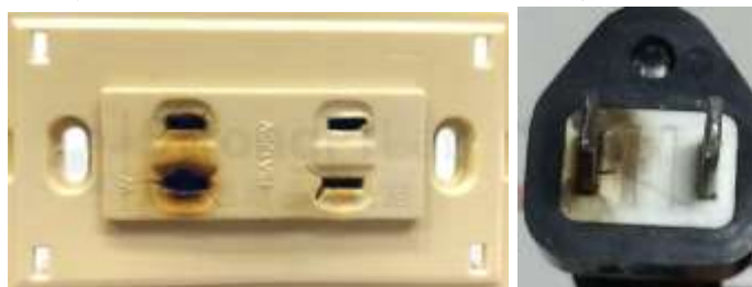
圖 2. 插座焦黑 圖 3. 插頭氧化
