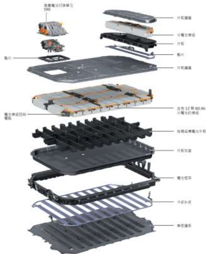
圖 6 pack 高壓電池組構造圖
