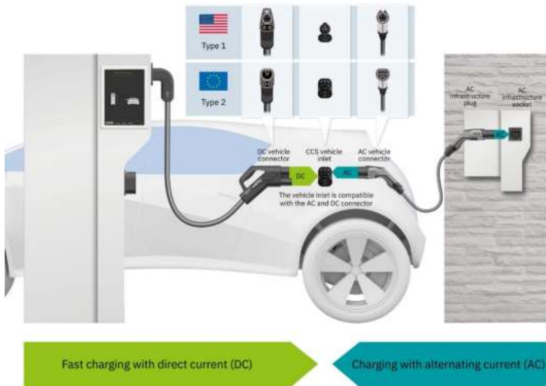
圖 7 直流快充站、交流充電座及各式充電樁頭示意圖
