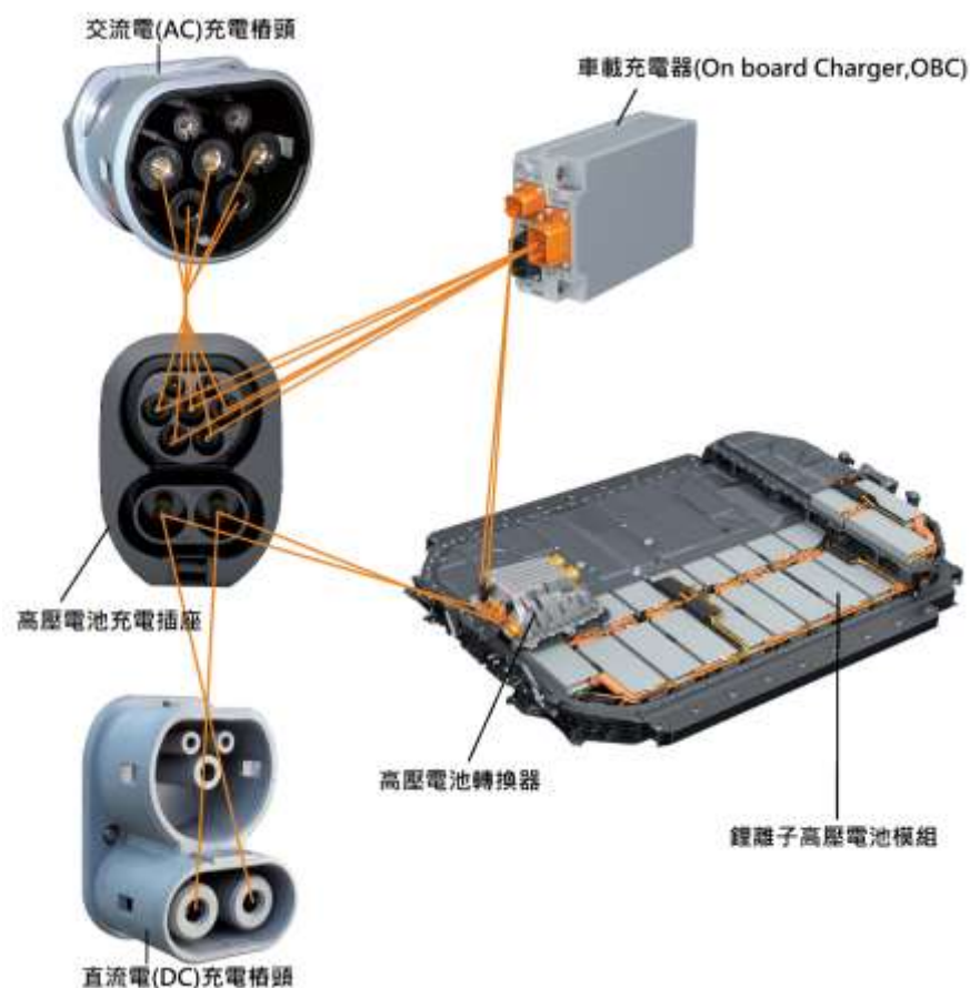
圖 1 電動車高壓電池充電系統架構圖
